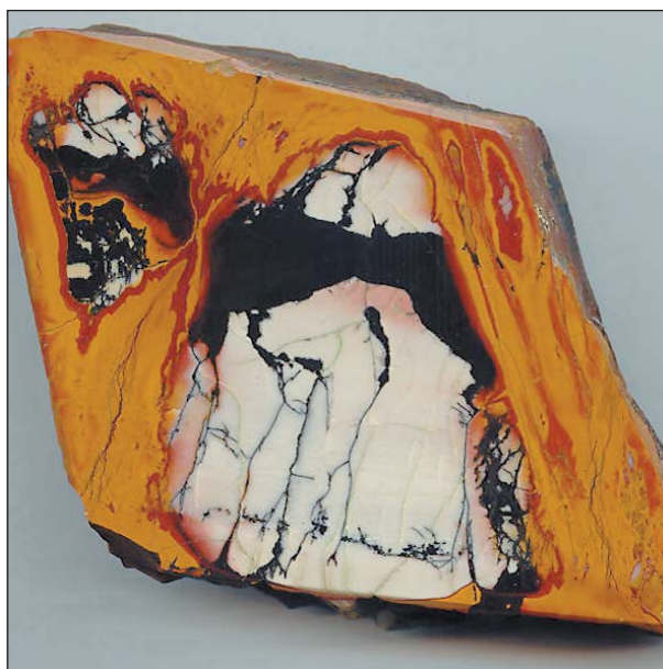
Обильные скопления черных оксидов марганца и красные полосы тонкозернистых агрегатов халцедона с оксидами железа в яшмах. Сопки Чиндауляй.
